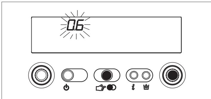
se il valore scende al di sotto di un valore minimo di sicurezza (0.3 bar), sul display si visualizza l'anomalia 41 per un tempo transitorio, trascorso il quale, se l'anomalia persiste, viene visualizzato il codice anomalia 40 (vedi paragrafo "4.8 Anomalie").
