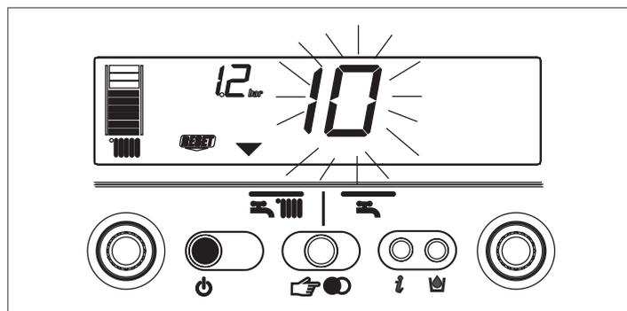
Premere il tasto
