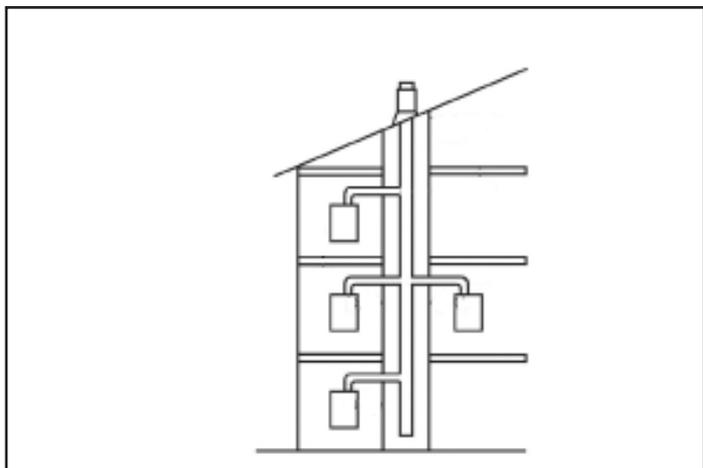
Le canne fumarie collettive in pressione positiva possono essere utilizzate soltanto per apparecchi a condensazione di tipo C. Di conseguenza la configurazione B53P/B23P è vietata.
