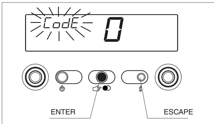
Inserire il codice password di accesso alle funzioni di TARATURA & SERVICE ruotando il selettore temperatura acqua sanitario fino ad ottenere il valore necessario.
