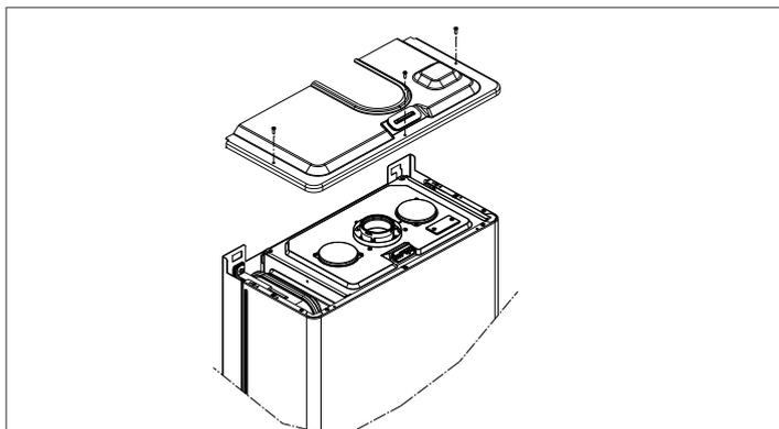
I condotti sdoppiati possono essere orientati nella direzione più adatta alle esigenze dell'installazione. Il condotto di aspirazione dell'aria comburente va collegato all'ingresso dopo aver rimosso il tappo di chiusura fissato con tre viti e fissato l'apposito adattatore. Il condotto scarico fumi deve essere collegato all'uscita fumi dopo aver installato l'apposito adattatore. Per l'installazione seguire le istruzioni fornite con il kit accessorio specifico per caldaie a condensazione.
