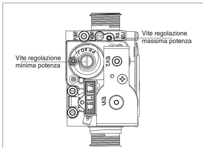
La caldaia viene fornita con le regolazioni riportate in tabella. È possibile però, in base alle esigenze impiantistiche oppure alle disposizioni regionali sui limiti di emissioni dei gas combusti, regolare tale valore facendo riferimento ai grafici riportati di seguito.
