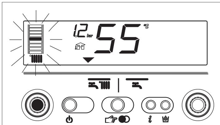
Se si desiderasse modificare il valore della temperatura, aumentandolo o diminuendolo rispetto a quello automaticamente calcolato dalla scheda elettronica, è possibile agire sul selettore temperatura acqua riscaldamento: in senso orario il valore di correzione della temperatura aumenta, in senso antiorario diminuisce.
