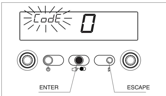
Inserire il codice password di accesso alle funzioni di modifica parametri ruotando il selettore temperatura acqua sanitario fino ad ottenere il valore necessario.
