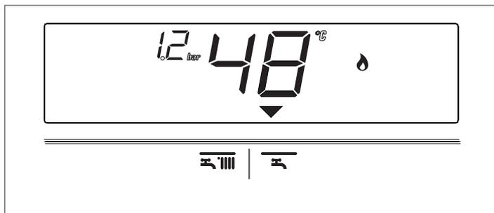
La caldaia resterà in funzione fino a quando saranno raggiunte le temperature regolate, dopodiché si porrà in stand-by.
