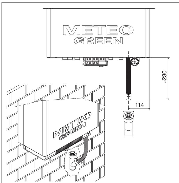
Posizionare il tubo flessibile di scarico condensa fornito con la caldaia, collegandolo al collettore (o altro dispositivo di raccordo ispezionabile appositamente predisposto come indicato nella UNI EN 677) evitando di creare pieghe dove la condensa possa ristagnare ed eventualmente congelare.
