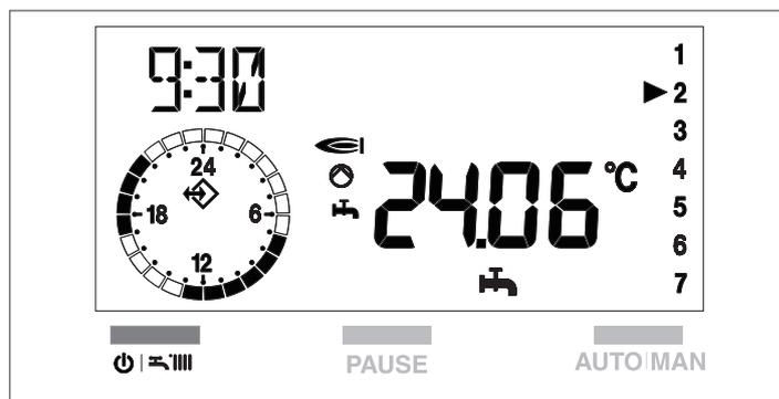
Alla fine del ciclo di autocontrollo, la caldaia è pronta per funzionare. Il display si presenterà come indicato in figura.
