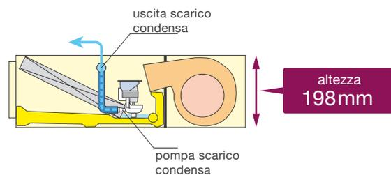
**LA POMPA DI SCARICO CONDENZA A CORREDO**
