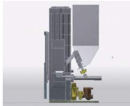
I fumi provenienti direttamente dalla combustione vengono direzionati con 2 collettori verso una fila di 10 tubazioni di scambio.
