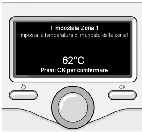
Modifica temperatura acqua calda riscaldamento
